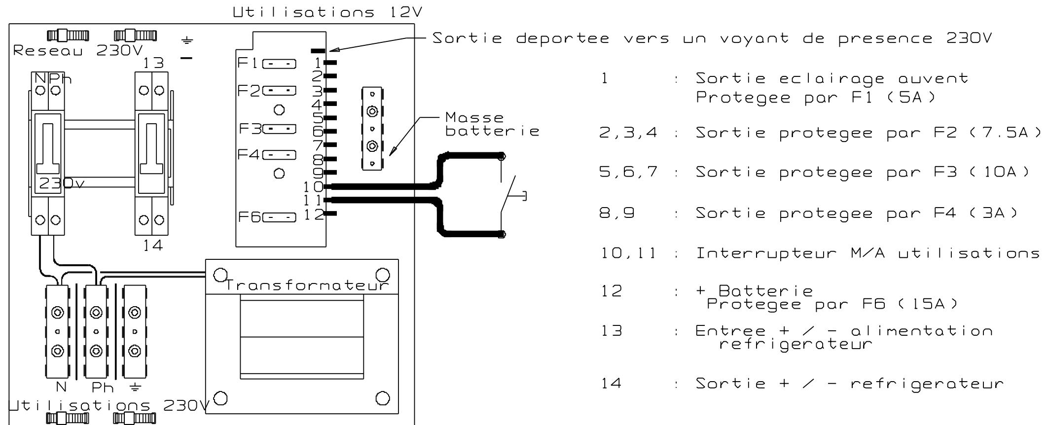
Protection du refrigerateur par un disjoncteur modulaire 16A
