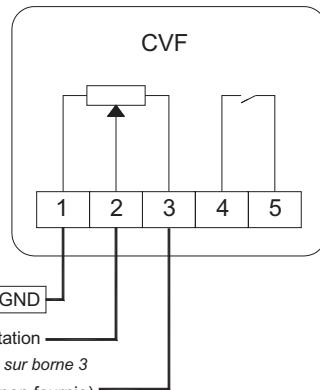
Signal de sortie : de 0V à la tension d'alimentation
