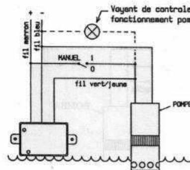
Pour un fonctionnement correct, placer ce boîtier (entièrement étanche) au dessus du niveau de la pompe.
