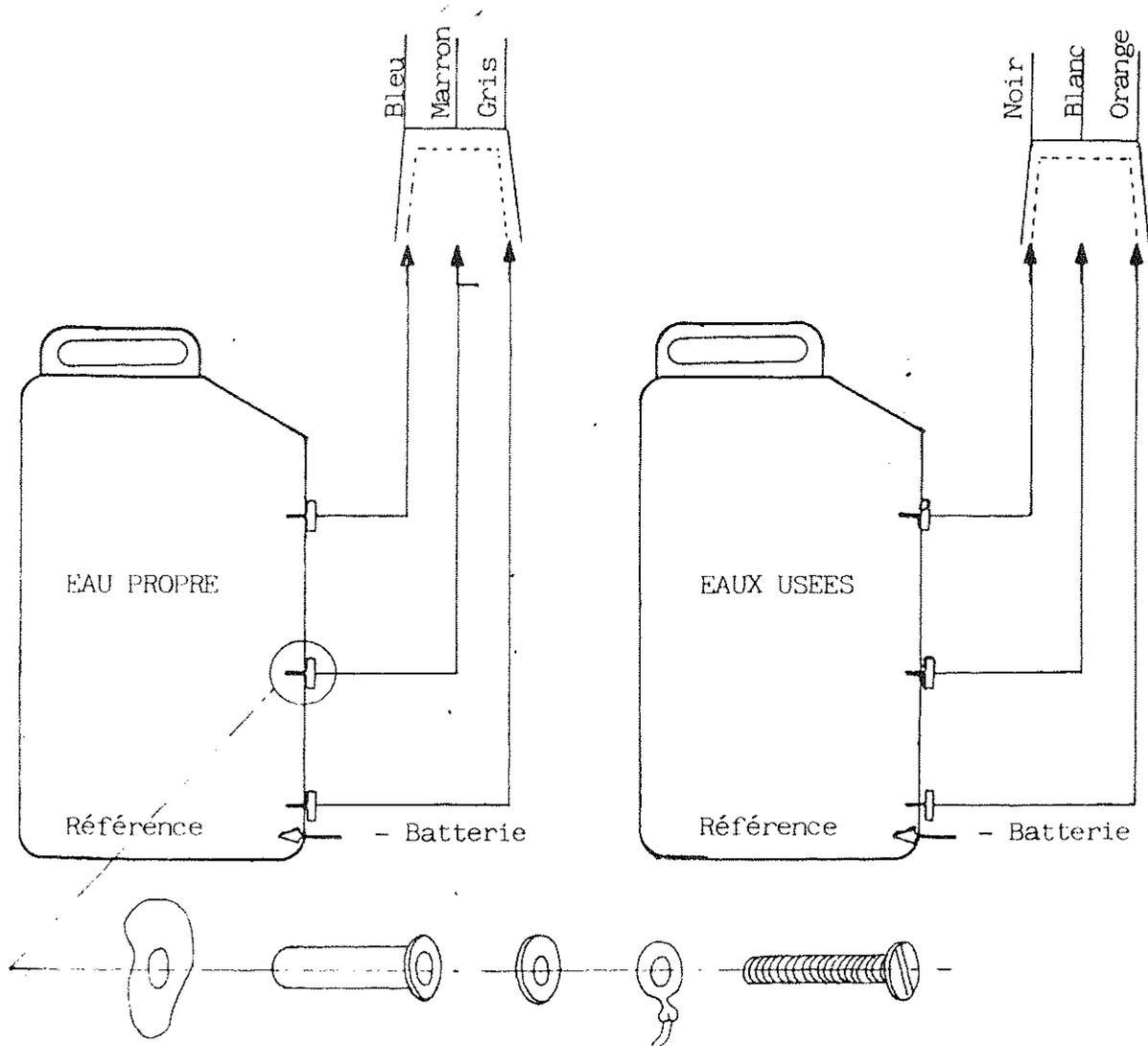
\* Tracer sur le réservoir la position des sondes en fonction de la géométrie et du volume de celui-ci. La sonde de référence est toujours placée en bas du réservoir (environ 5 cm du fond).
