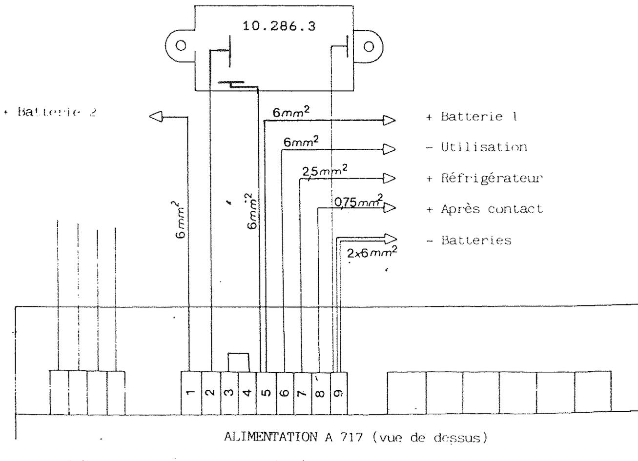
\* Positionner le strap extérieur entre les bornes 3 et 4.
