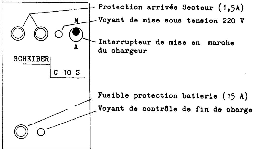
\* Coffret chargeur 220/12V 10 Amp permanent équipé d'un dispositif de coupure automatique en fin de charge.
