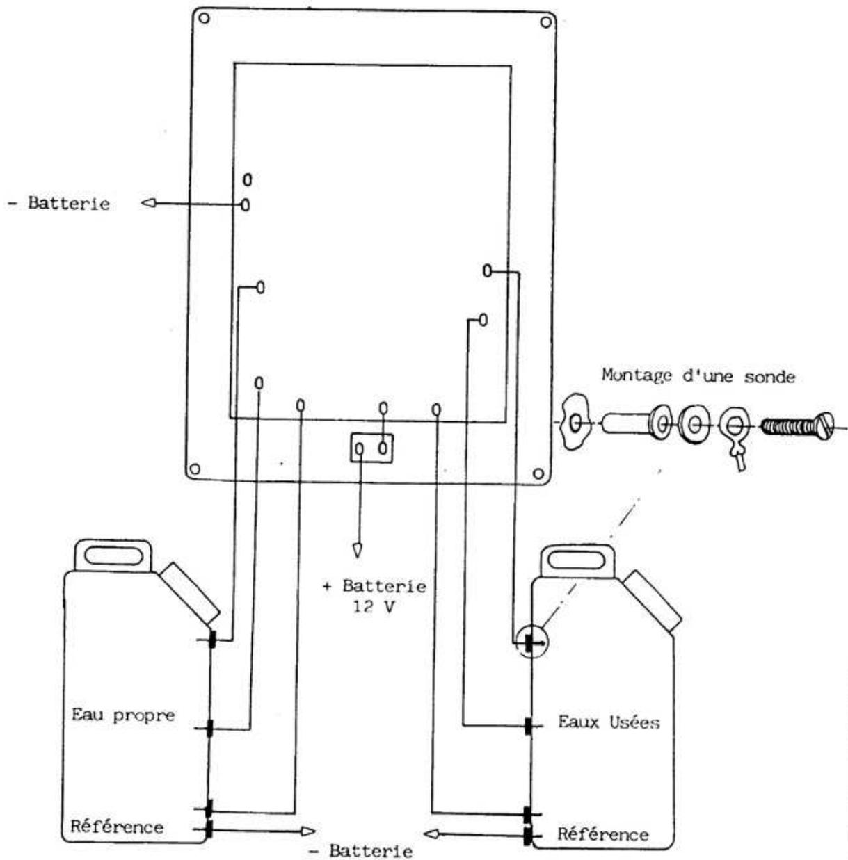
**RACCORDEMENT :** Liaisons fil souple de  $0,75 \text{ mm}^2$  de section
